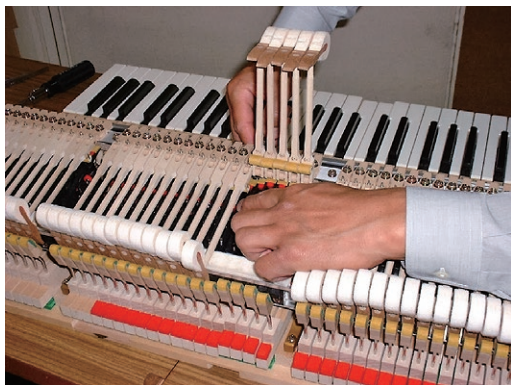
ハンマーを押し上げるジャックの高さを揃える。指先の感覚で紙一重の調整を行う
