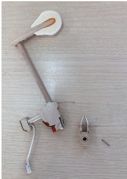
湿度により動きが悪くなったフレンジという部品の細かいピンを交換
