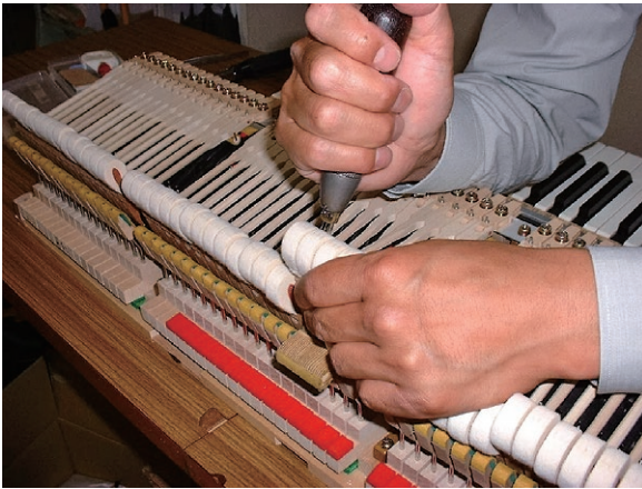
ピッカーリング。ハンマーフェルトに針を刺して全体の硬さのバランスを取ることで音色を揃える。音の芯、輪郭、伸びを整える重要な作業
