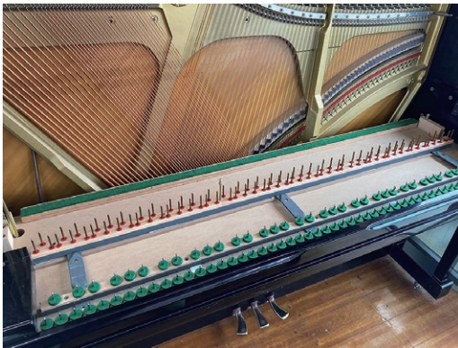
鍵盤を外し、内部のホコリや汚れ、サビを取り除くところから作業が始まる(写真はきれいに掃除されたあとのピアノ)
