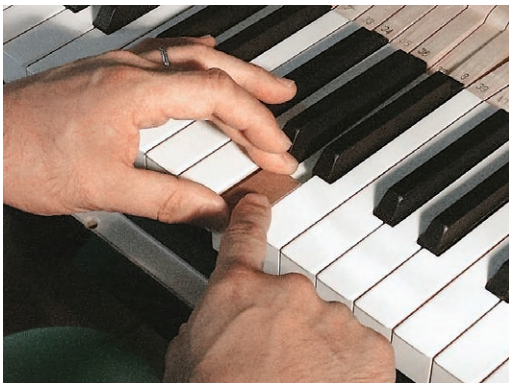
鍵盤が沈む深さを定規を使って揃えている。鍵盤の下に入っている薄い紙を出し入れして0.01ミリ単位の調整をする
